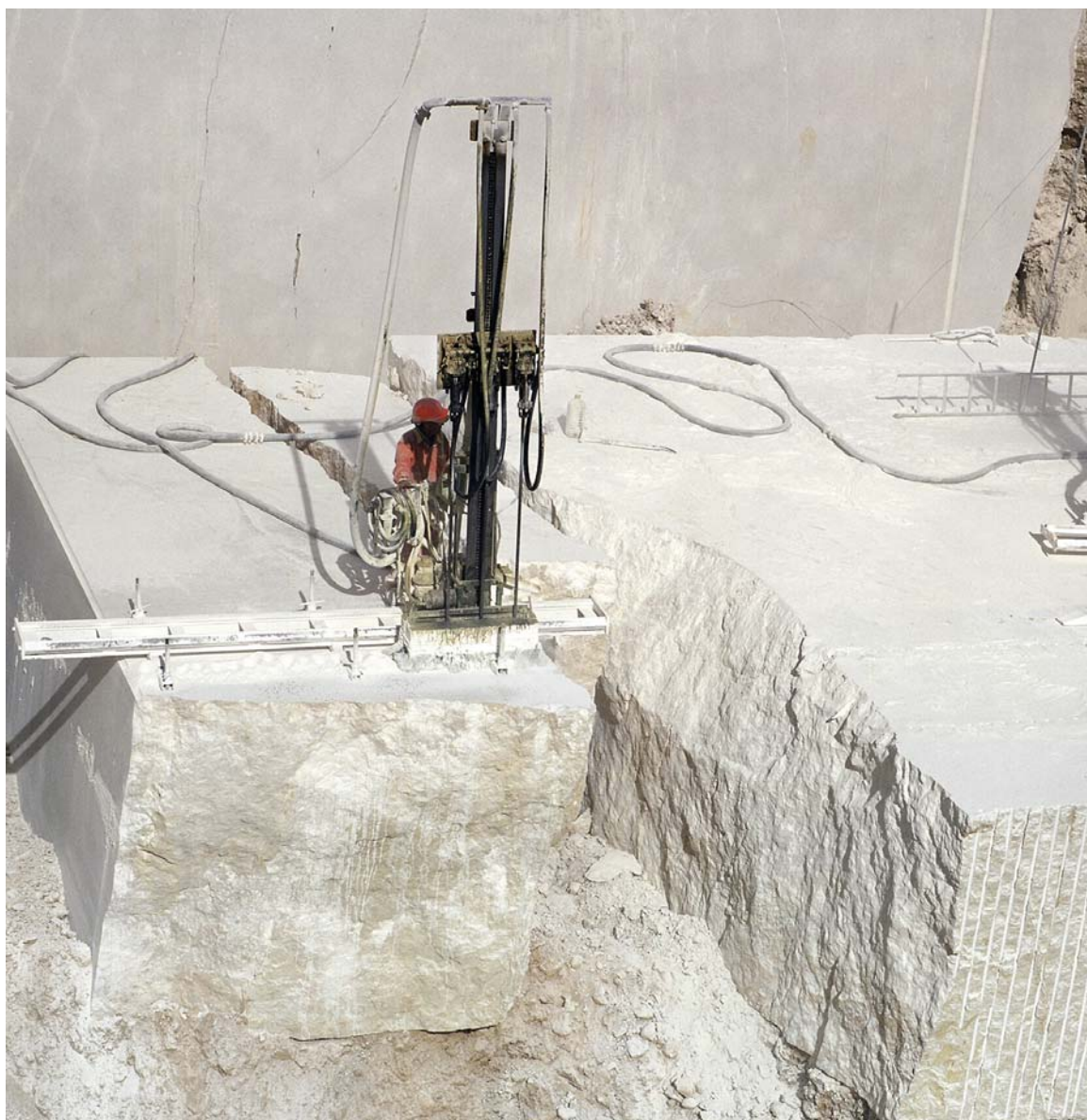
La spaccatura dei blocchi di granito in una cava di Aggus
